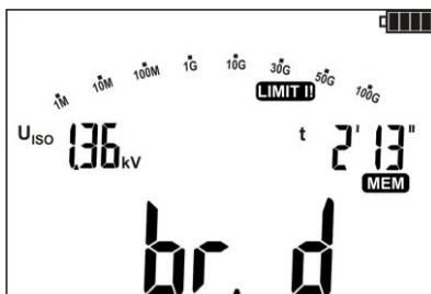
Si se excede la resistencia eléctrica en el aislamiento examinado y se produce un rotura, en el campo principal de la pantalla aparece el mensaje  $br. d$  - breakdown.
