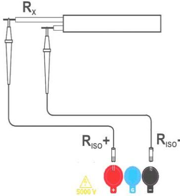
Conectar los cables de medición según la figura.
