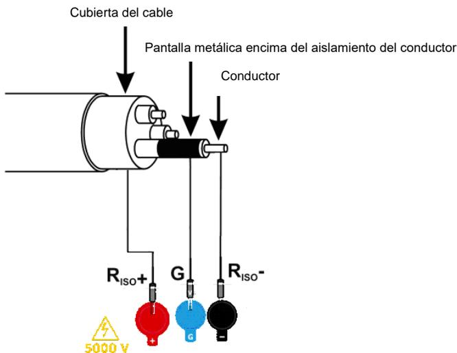
Del mismo modo es el proceso cuando se mide la resistencia de aislamiento entre dos conductores del cable, añadiendo a la pinza **G** otros conductores que no participan en la medición.
