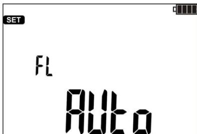
El medidor MIC-5001 tiene un filtro analógico que elimina la componente alterna de la corriente y permite realizar mediciones en el entorno de fuertes interferencias electromagnéticas. La activación de filtración FL prolonga un poco el tiempo de la estabilización de las mediciones realizadas. El medidor tiene 3 modos de funcionamiento del filtro.
