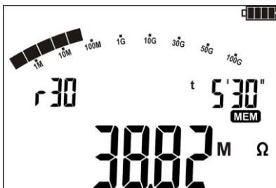
Valor de la resistencia  $R_{ISO}$  medida en el tiempo  $t=5'30''$ . El símbolo  $r 30$  indica el intervalo de tiempo seleccionado en el que se registró esta resistencia.
