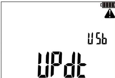
2. Conectar el cable al puerto USB del ordenador y al puerto USB del medidor.
