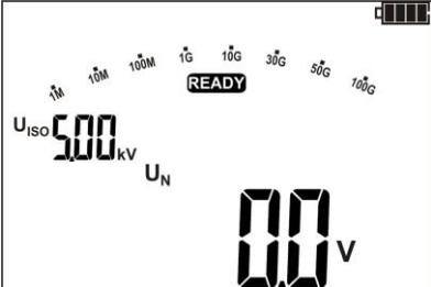
El medidor indica la disposición para medir con la tensión creciente.
