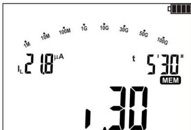
La corriente de fuga  $I_L$  medida en el tiempo  $t=5'30''$ . El símbolo  $L 30$  indica el intervalo de tiempo seleccionado en el que se registró esta corriente de fuga.
